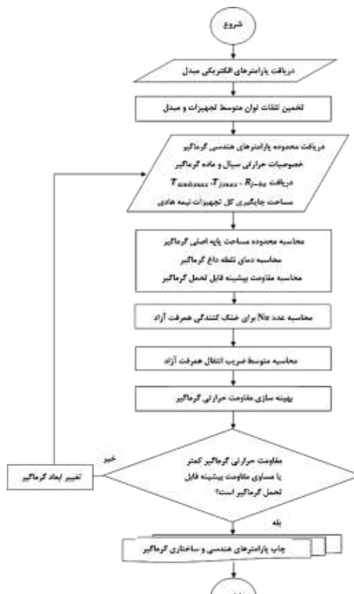
شکل ۹ - نمودار گردش کلی طراحی و بهینه‌سازی گرماگیر
