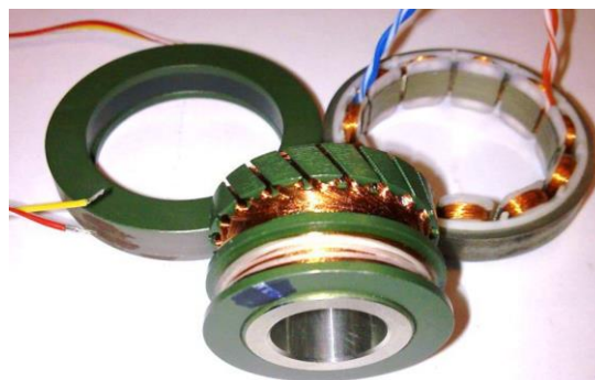
شکل ۳: استاتور و رتور ریزالور مورد مطالعه به همراه اولیه و ثانویه ترانسفورماتور گردان (نمونه عملی ساخته شده)
