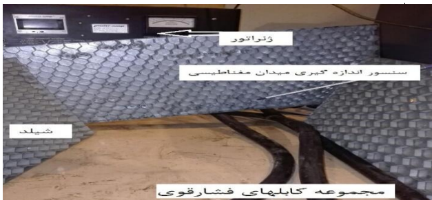
شکل ۳- اندازه گیری میدان تداخلی سه کابل فشار متوسط تک هسته ای مجاور در آزمایشگاه مرکز تحقیقات فشار متوسط و مواد مغناطیسی دانشگاه علم و صنعت ایران
