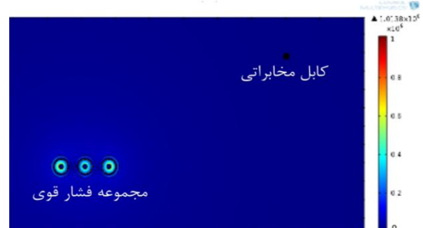
شکل ۵- خروجی نرم‌افزار برای میدان الکتریکی (V/m) در حالت اول- هر دو کابل بدون پوشش الکترومغناطیسی
