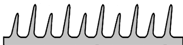
شکل ۶: مشخصات هندسی مقره نوع C
