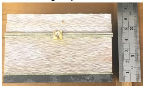
(ب) آنتن جاسازی شده در ساختار چندلایه
