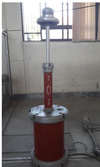
شکل ۱: ترانسفورماتور و مقاومت محدودکننده به منظور تأمین ولتاژ فشارقوی
