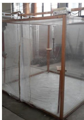
شکل ۵: نمایی از محفظه تست جریان نشتی و ولتاژ قوس الکتریکی مقره‌های پلیمری مورد مطالعه
