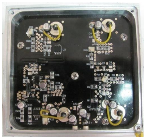
شکل ۲۴: تقویت کننده کم نویز متوازن بخش تغذیه DC
