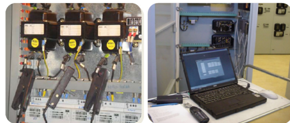
شکل ۲۶: اندازه‌گیری عملی هارمونیک‌های جریان ورودی
