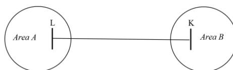
شکل ۱- سیستم قدرت به هم پیوسته ۲ ناحیه ای
