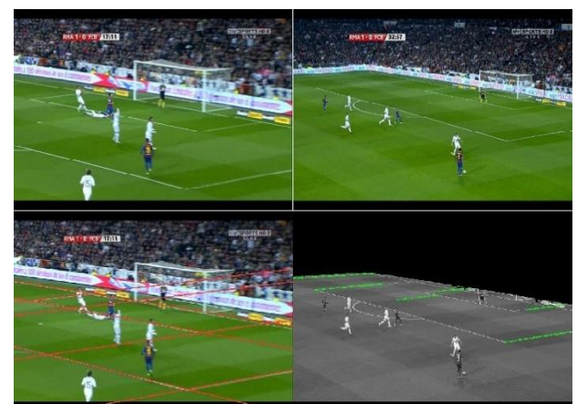
شکل (۸): دو نمونه از تصاویر ناموفق در استخراج خطوط مناسب (تصاویر بالایی). خطوط استخراج‌شده به اشتباه از تصاویر بالایی (تصاویر پایینی).
