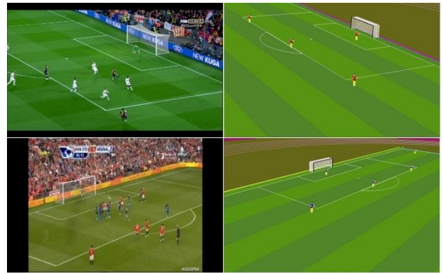
شکل (۶): دو مثال از تخمین موقعیت دوربین در تصاویر واقعی (تصاویر سمت چپ) و تصاویر مصنوعی تهیه‌شده با استفاده از پارامترهای دوربین محاسبه‌شده (تصاویر سمت راست).
