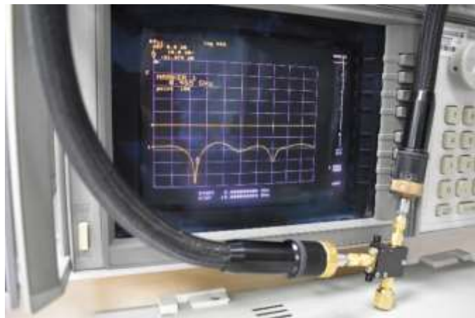
شکل ۱۱: افت بازگشتی دهانه‌ی ورودی تقسیم‌کننده‌ی توان ساخته‌شده هنگام اتصال به تحلیل‌گر شبکه (هر خانه معادل 10\text{dB} است).
