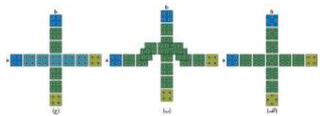
شکل ۷: روش‌های عبور دو سیم QCA از روی یکدیگر؛ (الف) با استفاده از ترکیب سلول‌های مربع و لوزی، (ب) با استفاده از قابلیت پیاده‌سازی چندلایه، (ج) با استفاده از اختلاف فاز مناطق زمانی
