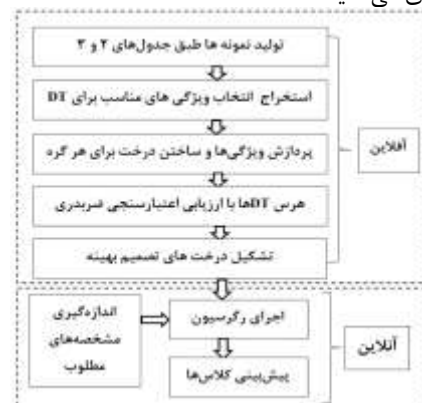
شکل ۶- الگوریتم پیشنهادی به‌منظور حفاظت ازدست‌رفتن تحریک
