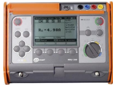
شکل ۳: دستگاه MRU-200 به منظور اندازه‌گیری مقاومت پای برج
