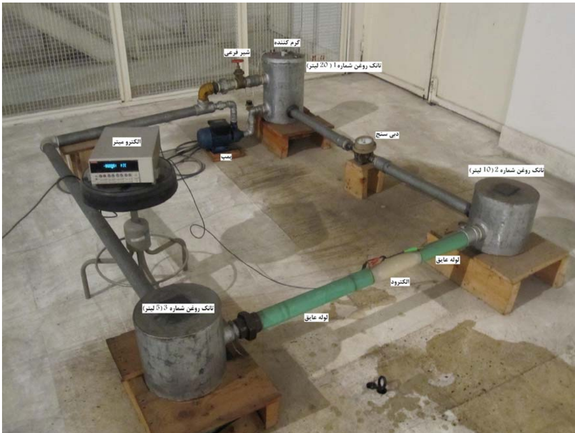
شکل ۳- تجهیزات مدار حلقه بسته
