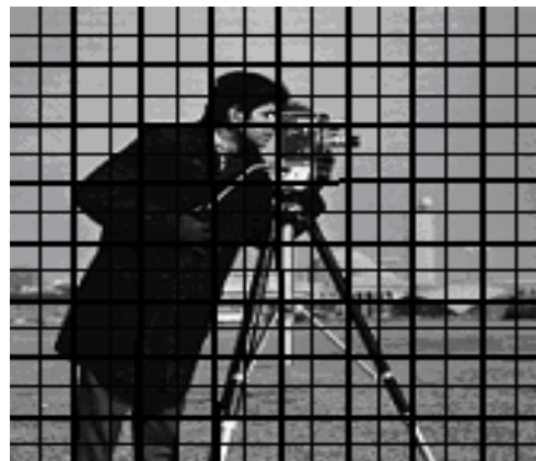
شکل ۳- بلوک‌بندی اولیه یک تصویر جهت تحلیل آماری مقادیر پیکسل‌ها برای قطعه‌بندی تصویر
