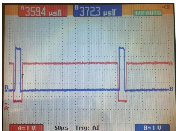
شکل ۱۹: شکل موج سیگنال‌های فرمان (اثر Dead time)
