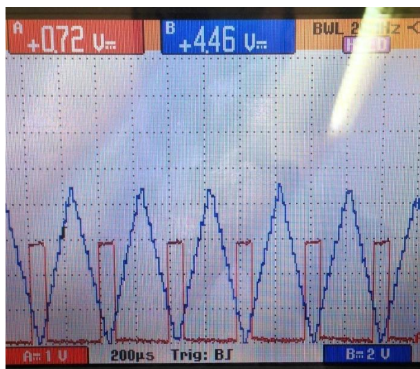
شکل ۲۰: سیگنال حامل مثلثی به همراه سیگنال فرمان تولید شده
